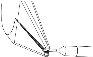
Verwenden Sie eine Flachzange um die Tastkopfspitze vorsichtig zu greifen.
